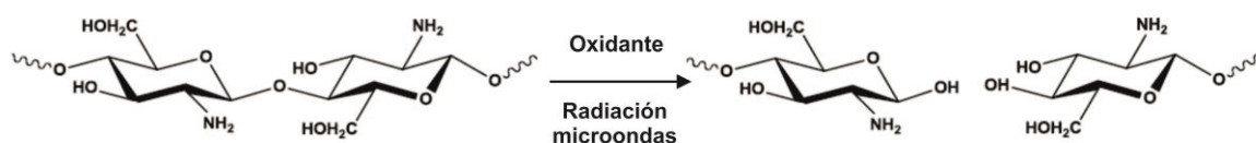
Figura 1: Representación esquemática de la síntesis de oligómeros de quitosano.
